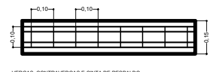
VERGAS, CONTRAVERGAS E CINTA DE RESPALDO DE PAREDE COM FERRO DE 8mm E ESTRIVO DE 4,3mm
